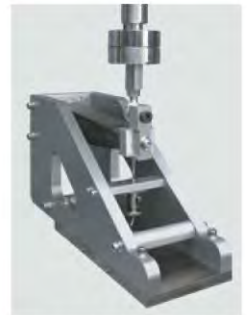
梯形梁两点弯曲试验模块
