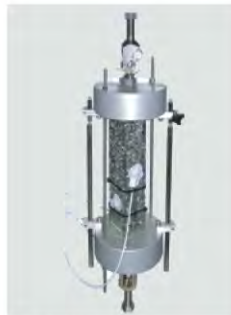
约束试件温度应力试验模块
